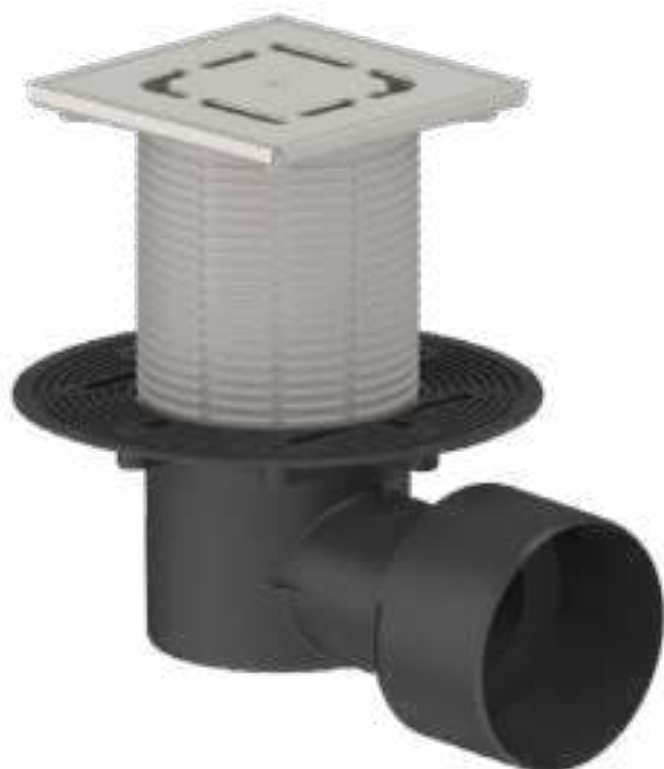
ТП-5100-3000 Трап регулируемый с горизонтальным выпуском 75/110 мм
