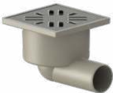
ТП-101.40-100HS(Hs+Ms) Трап с двойным затвором и горизонтальным выпуском 40 мм
